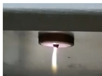
photo du jet de plasma d'air obtenu
